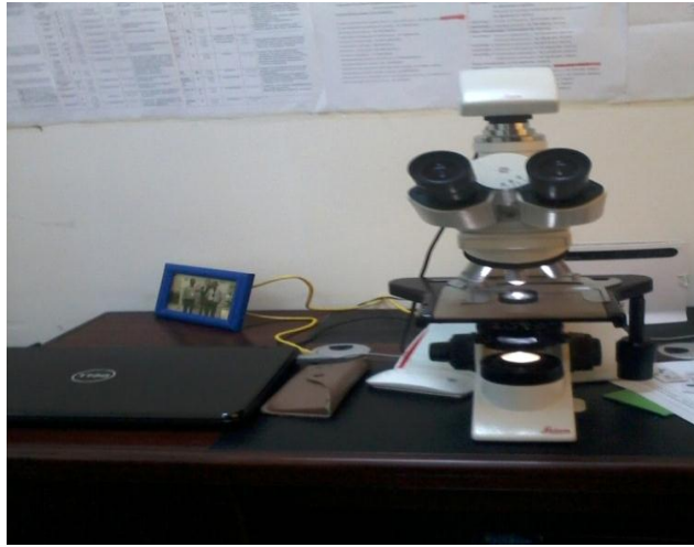
Figure n° 14 : Microscope optique avec caméra numérique intégrée Service d'Anatomie Pathologique, CHU Douira, Alger (Mimoune, 2016)
