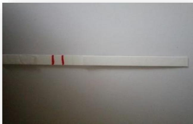
**Figure n° 12 : Bande de test d'antibiotique positif (01) (photo personnelle)**
