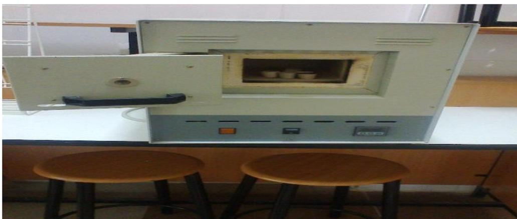
**Figure 21 :** Four à moufle, réglable jusqu'à 550 °C dosage des cendres.
