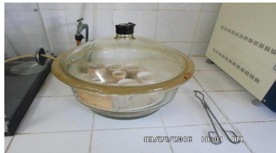
**Figure 20 :** Etuve et dessiccateur utilisée dans la méthode thermogravimétrique.
