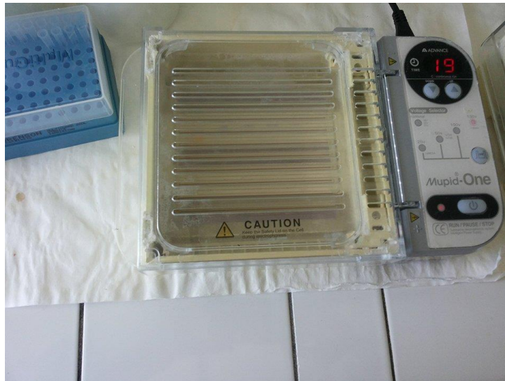
Figure 9: Electrophorèse d'ADN sur gel d'agarose la migration du colorant de charge de la cathode vers l'anode (photo personnelle).
