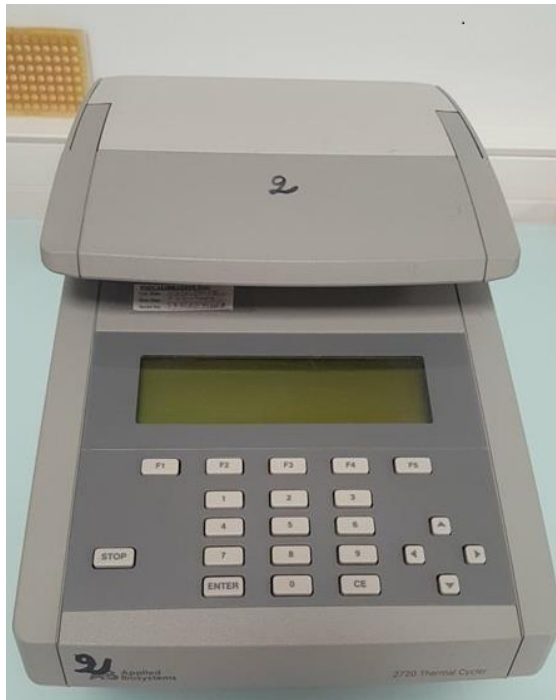
Figure 8: le thermocycleur utilisé pour la détection de Coxiella burnetii par PCR standard (photo personnelle).
