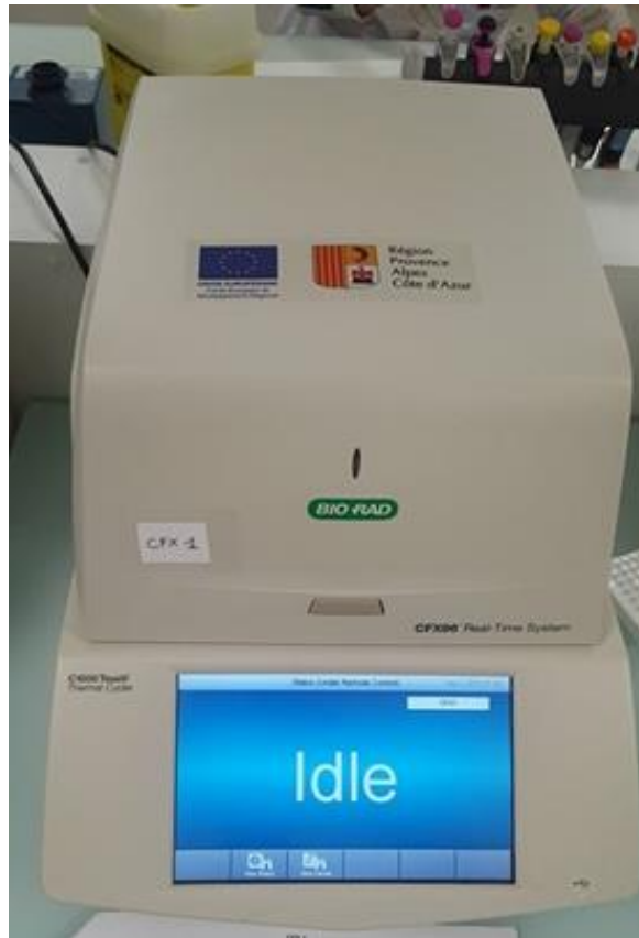
Figure 7: qPCR (type CFX96TM, Bio-rad, California, USA) utilisé pour la détection de Coxiella burnetii dans les tissus placentaires (photo personnelle).
