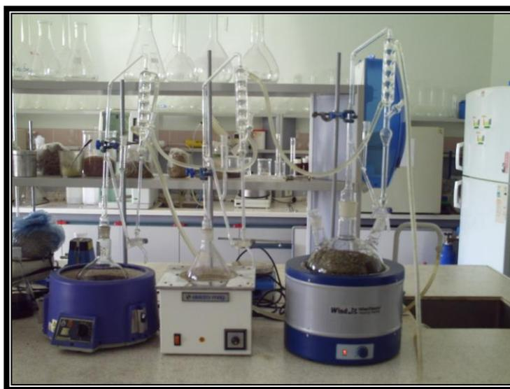
**Figure n° 8 :** Unité d'hydrodistillation de type Clavenger
