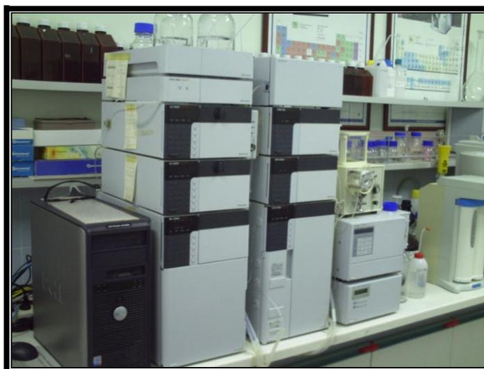
**Figure n° 10:** Chromatographe en phase liquide à haute performance (HPLC)
