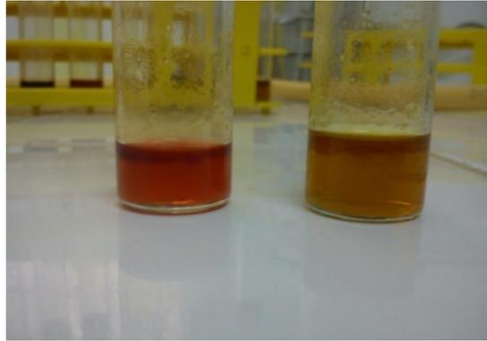
**Figure 9 :** Recherche de la production d'indole (résultat positif à gauche, négatif à droite)
