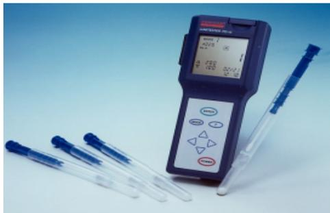
**Figure 03** : ATPmètre « LUMITESTER PD-10 » et un écouillon « lucipac W »
