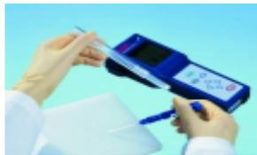
**Figure 04 :** Ecouvillonnage de la surface à testé avec un angle de 45°C.
