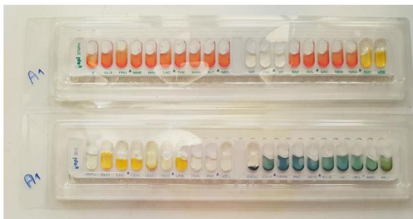
**Figure 34 : 2 tests d'identification biochimique sur galerie Api pour un échantillon polymicrobien (photo personnelle).**
