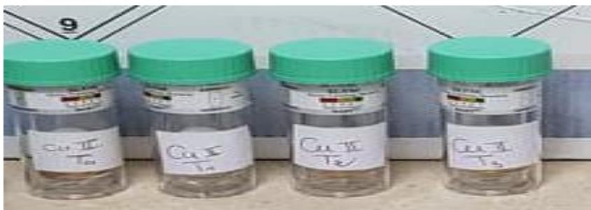
**Figure 10 : Tube de prélèvement SLIM B.A.R.T. (photo personnelle).**
