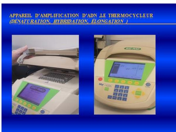
Figure22 : appareil d'amplification d'ADN (dénaturation, hybridation, élongation)
