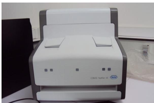
Figure 17: COBAS TaqMan 48 : extracteur semi automatique en temps réel
