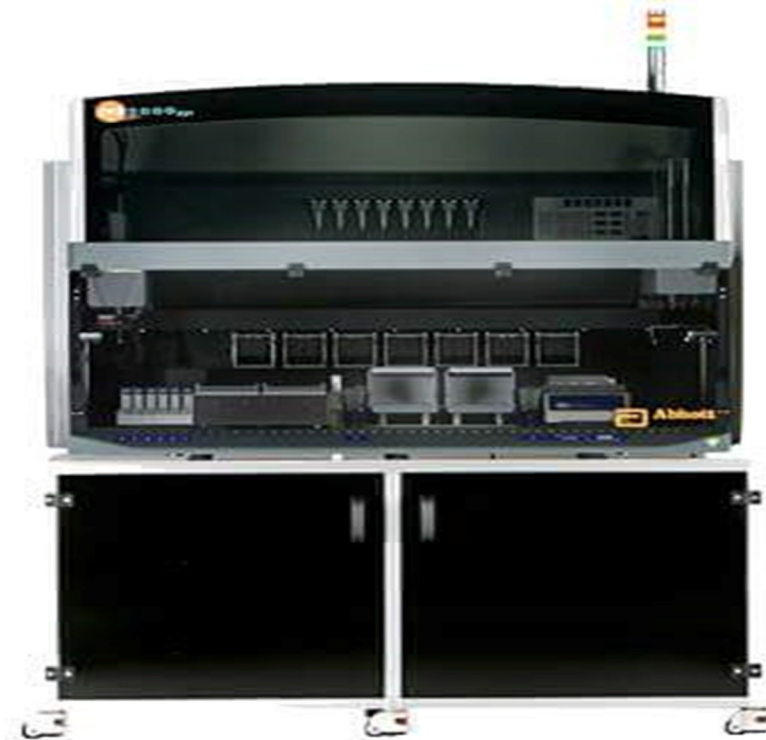
Figure23 : M2000 abbot , PCR en système fermé utilisé pour les hépatites virales
