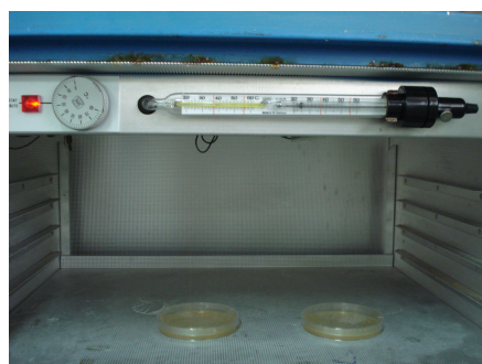
Photos 14:Mise des prélèvements dans une étuve à 27° C pendant 2 à 3 semaines
