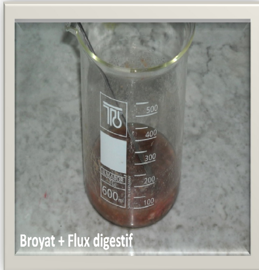
Figure 13 : mélange du broyat de muscle avec le flux digestif
