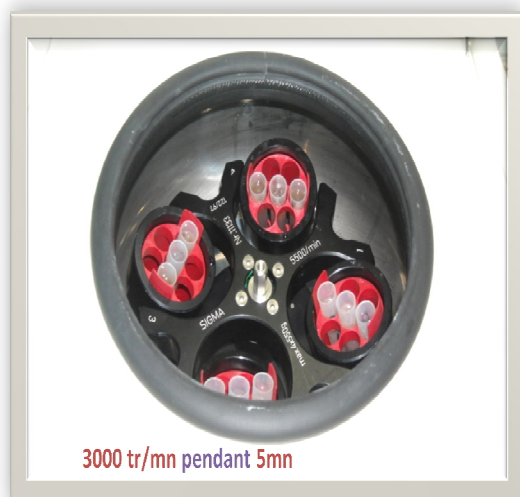
Figure 16 : Centrifugation du filtrat à 3000 tours par minute durant 5 minutes.
