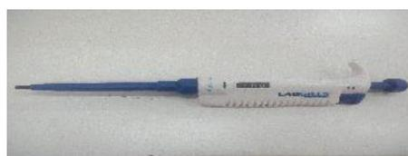
**photo2 : Micropipette de 0,1 ml**
