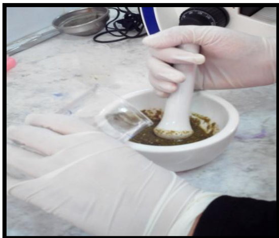
Figure 15 : Rajout de la solution dense (chlorure de zinc)
