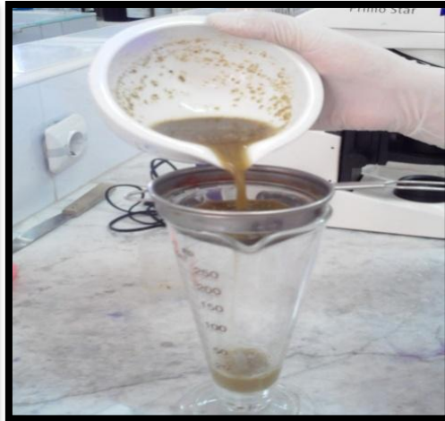
Figure 17 : Filtrage du mélange à travers un tamis
