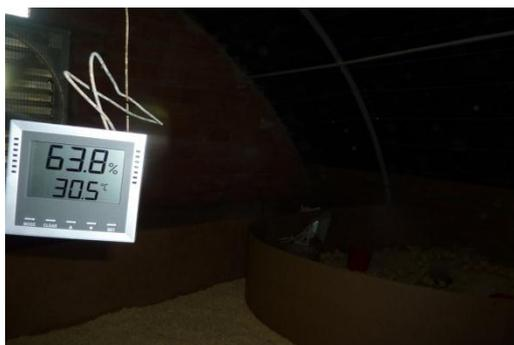
**Photo 6 : thermomètre couplé à un hygromètre**
