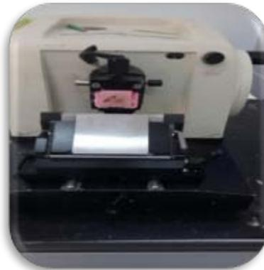
**Figure 16:** Microtome LEICA RM2125 RT (originale)
