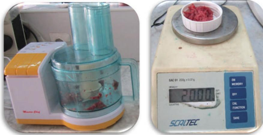
**Photo 3 :** Broyage et pesée échantillons (dekkiche)
