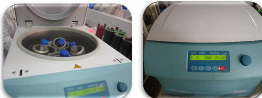
**Photo 7 :** Centrifugation du filtrat à 3000 tours par minute durant 5 minutes (dekkiche).
