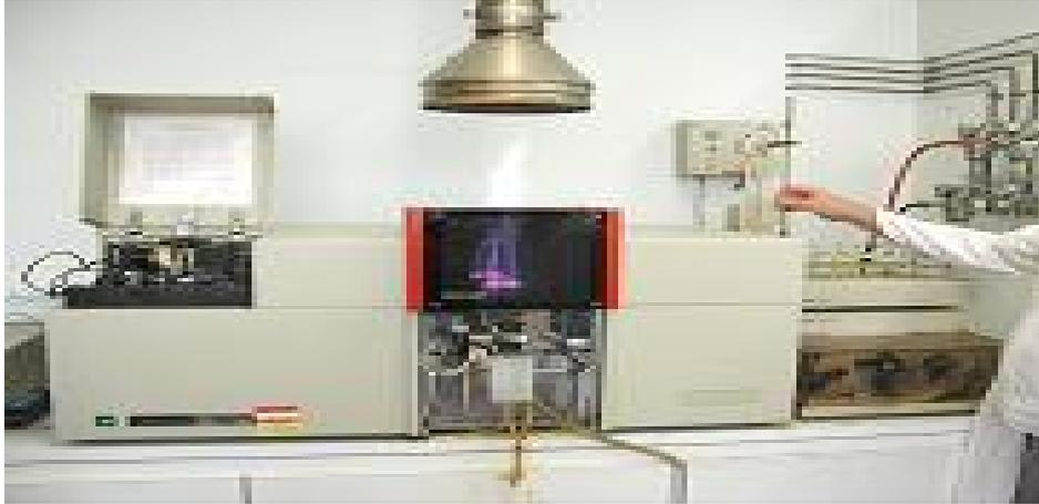
**Photo 1 : Spectrophotomètre d'absorption atomique à vapeur froide.**
