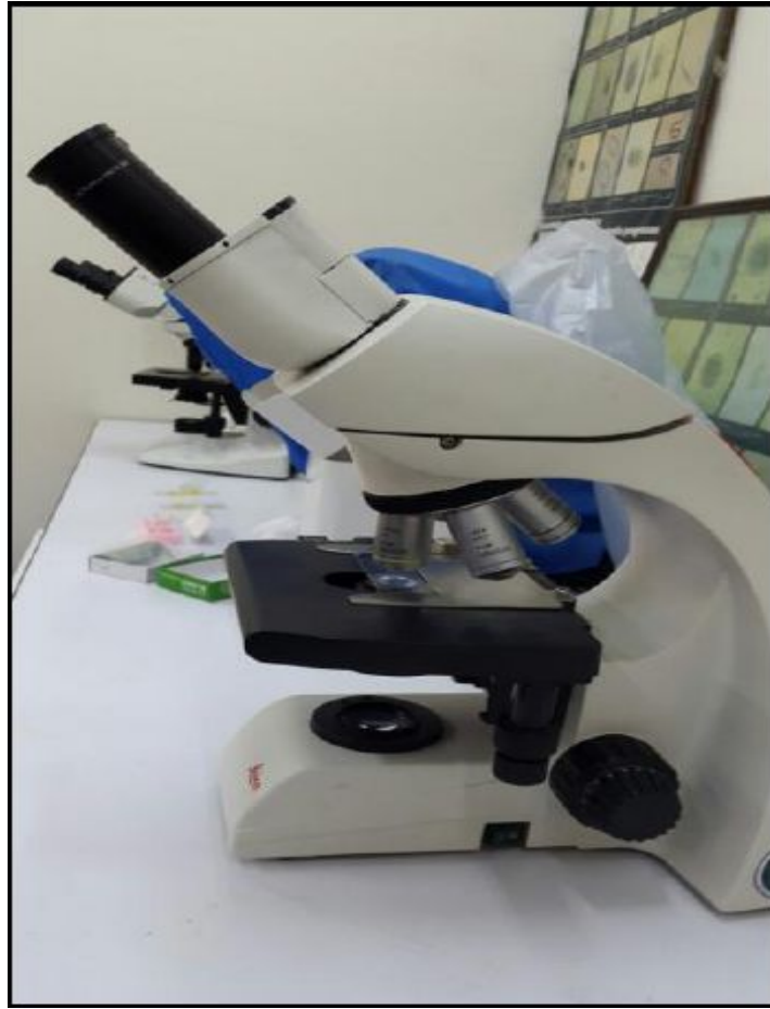
Figure 20 : Microscope binoculaire utilisé pour la lecture des lames.
