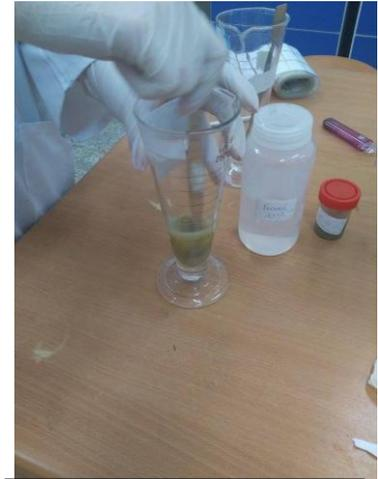
3. Agiter a l'aide d'un agitateur en acier jusqu'à l'obtention d'une dilution homogène
