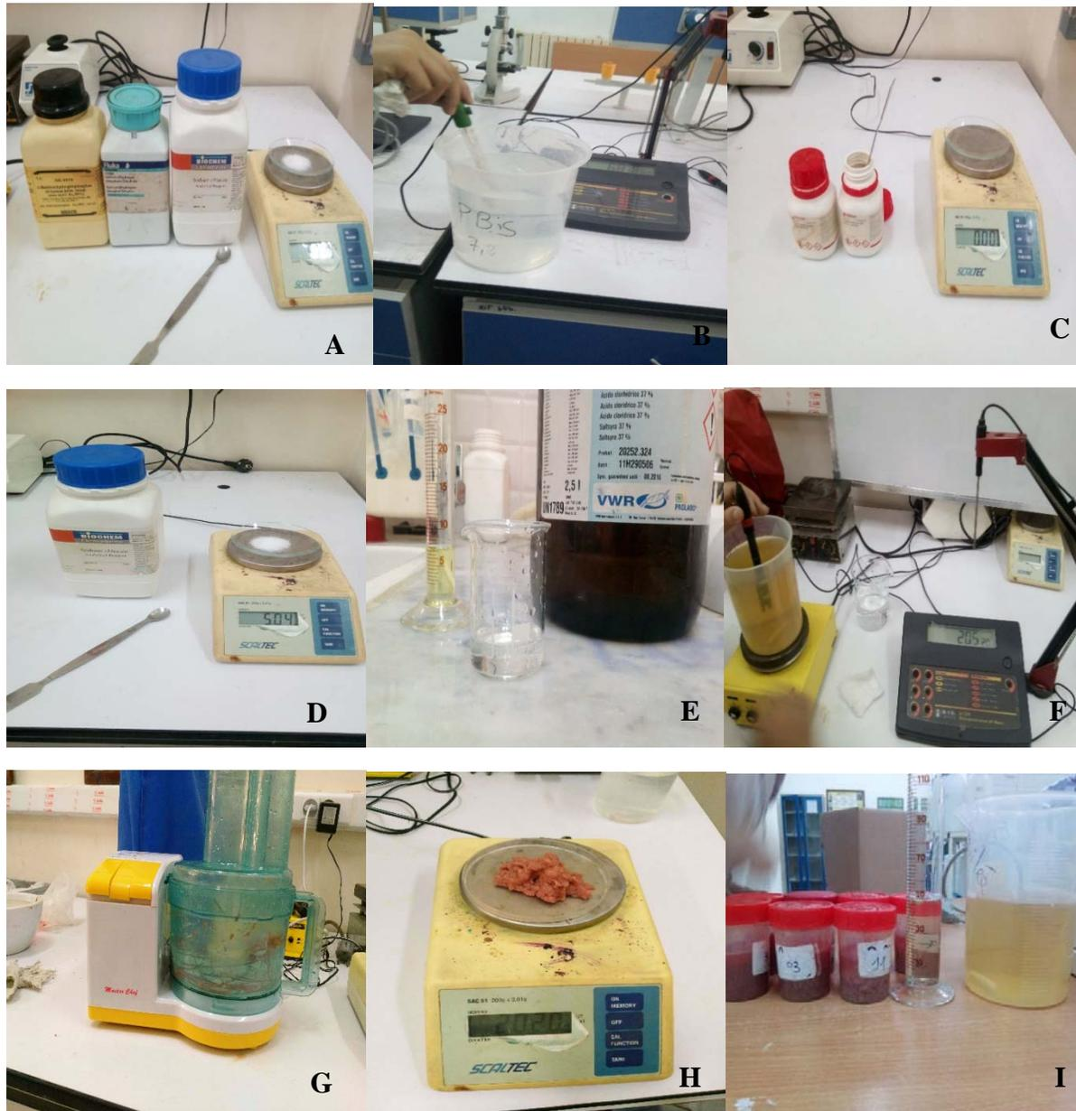
**Figure 01:** Étapes de la digestion enzymatique : (A)Pesée des composants du PBS , (B)Étalonnage du pH du PBS,(C)Pesée de la pepsine, (D) Pesée du NaCl, (E) Préparation du HCl 25%, (F) Calibrage du pH de la solution de digestion, (G) Broyage des échantillons,(H) Pesée des broyats, (I) Ajout de la solution de digestion aux broyats (Photos Ardache et Benamghar , laboratoire de Parasitologie et Mycologie de ENSV, 2018).
