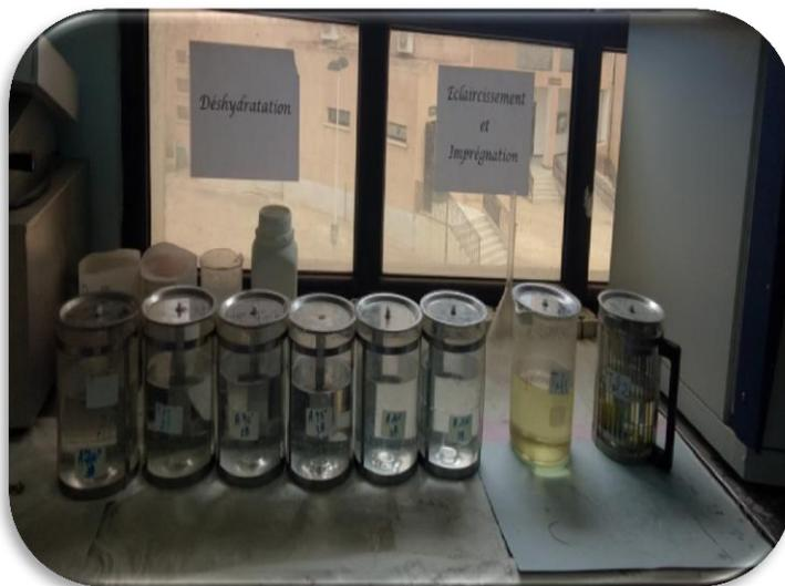
**Figure 18 : Déshydratation par des bains d'alcool successifs à concentration croissante (originale)**
