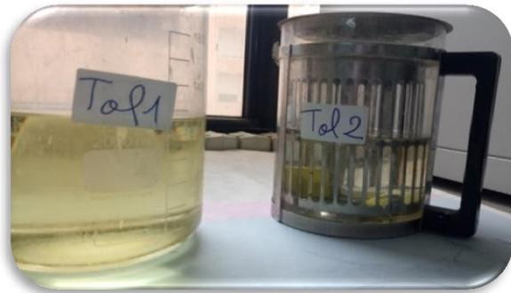
**Figure 19 : L'éclaircissement par bain de toluène (originale)**
