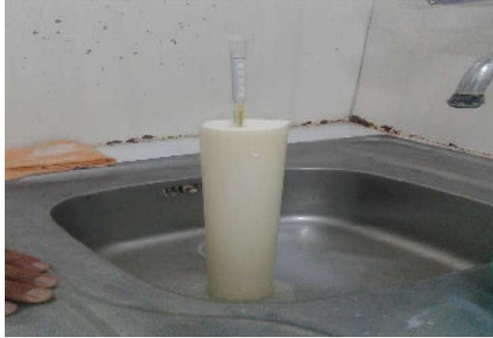
**Photo 02: mesure de la densité par le thermo lactodensimètre (photo personnelle)**
