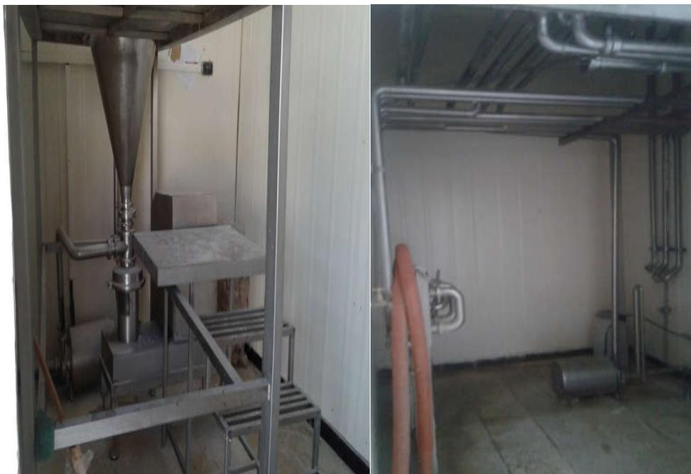
**Photo 6 : Entonnoir de la poudre et les pompes et salle de dépotage (photo personnelle)**
