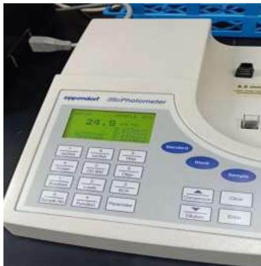
**Figure 61** : Eppendorf BioPhotometer pour la quantification de l'ADN
