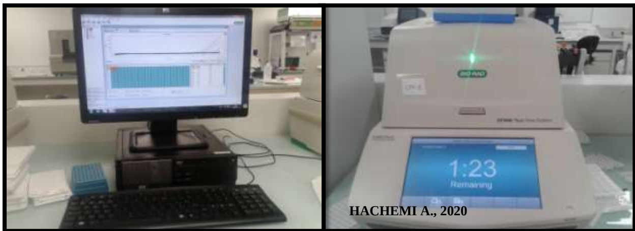
Figure 11. Appareil de PCR quantitative en temps réel, piloté par un ordinateur qui permet l'acquisition et le suivi en temps réel des données ainsi que leur traitement. (qPCR CFX96™, Bio-Rad, California, USA). (Photos personnelles, prises en Janvier 2019)
