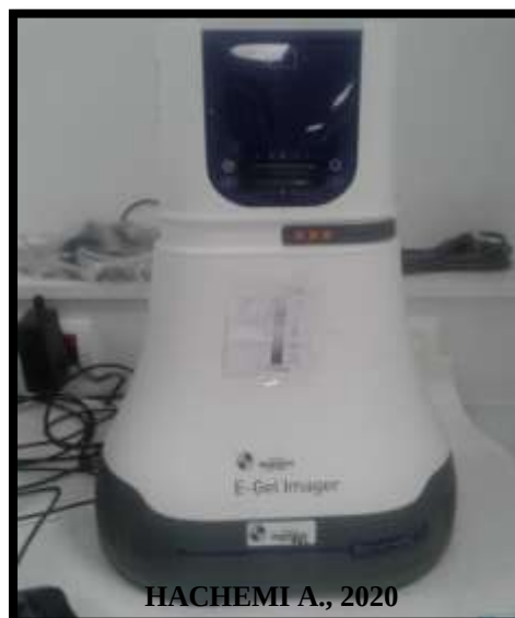
Figure 14. Imageur moléculaire pour la lecture du gel d'électrophorèse (Photo personnelle, prise en Décembre 2018)
