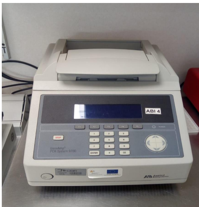
Figure 13: Thermocycleur (GeneAmp PCR System 9700, AB Applied biosystems, California, USA) utilise dans la réaction de PCR (Photo personnelle).
