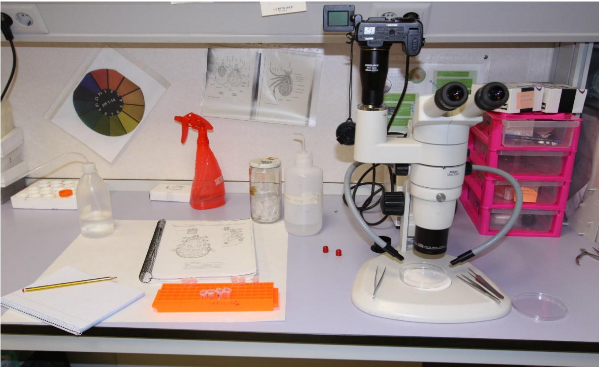
Figure 11: Microscope utilisé dans l'identification morphologique des arthropodes. « Nikon SMZ1000 ».
