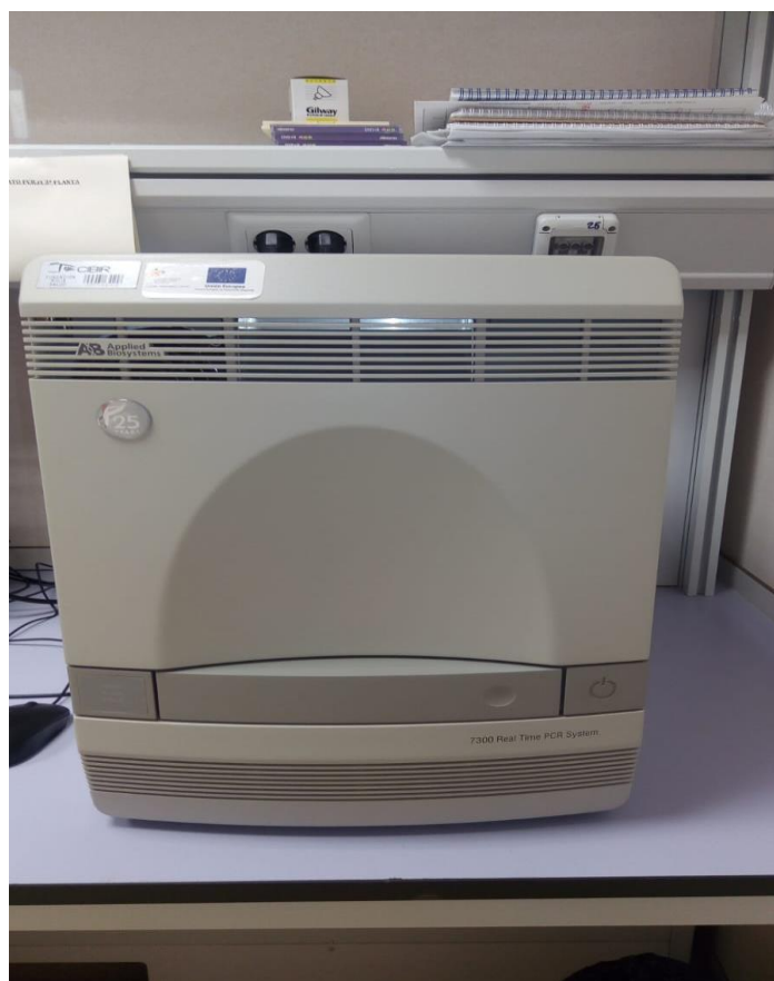
Figure 14: 7300 Real Time PCR System. APPLIED BIOSYSTEMS, California, USA. Utilisé pour la détection de C. burnetii dans les tiques
