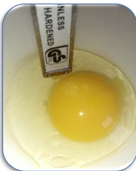
**Photo 8:** Mesure de la hauteur d'albumen épais à l'aide d'une règle millimétrée (Photo personnel .2019).
