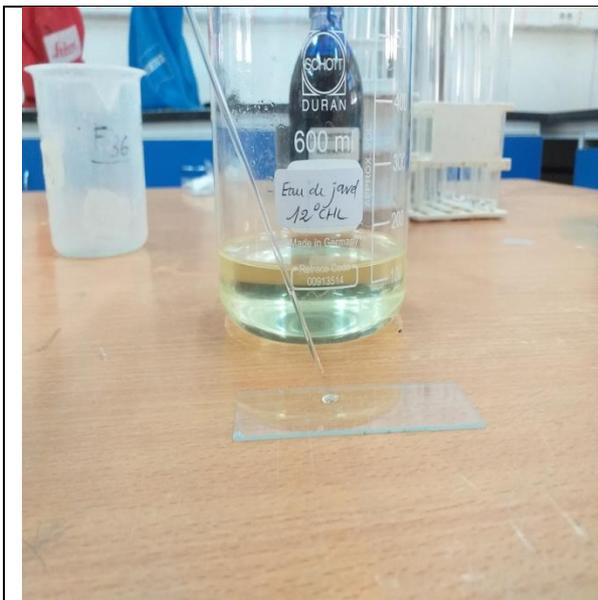
**Figure19:** Dépôt d'eau de javel pure sur lame contenant la goutte de solution fécale
