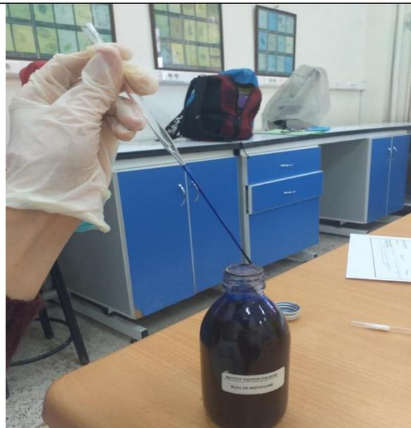
**Figure21:** Prélèvement du bleu de méthylène à l'aide d'une pipette pasteur
