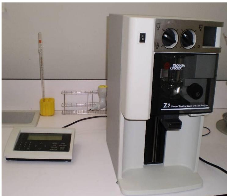
Figure 3.7 : Coulter Counter modèle Z2 (avec son clavier à gauche)
