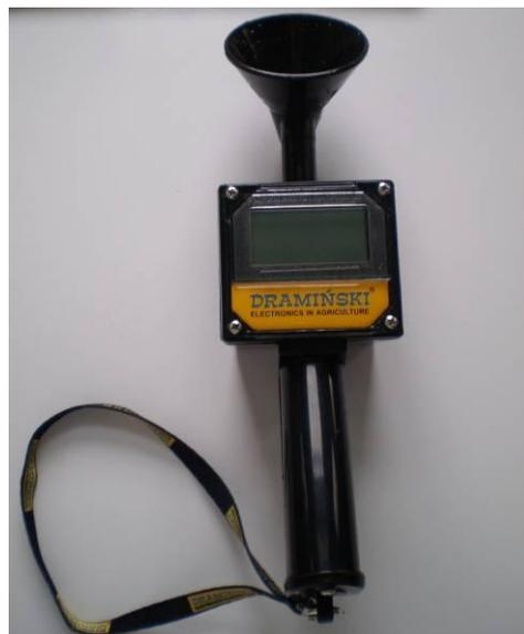
Figure 3.12 : Conductimètre type DRAMINSKI®
