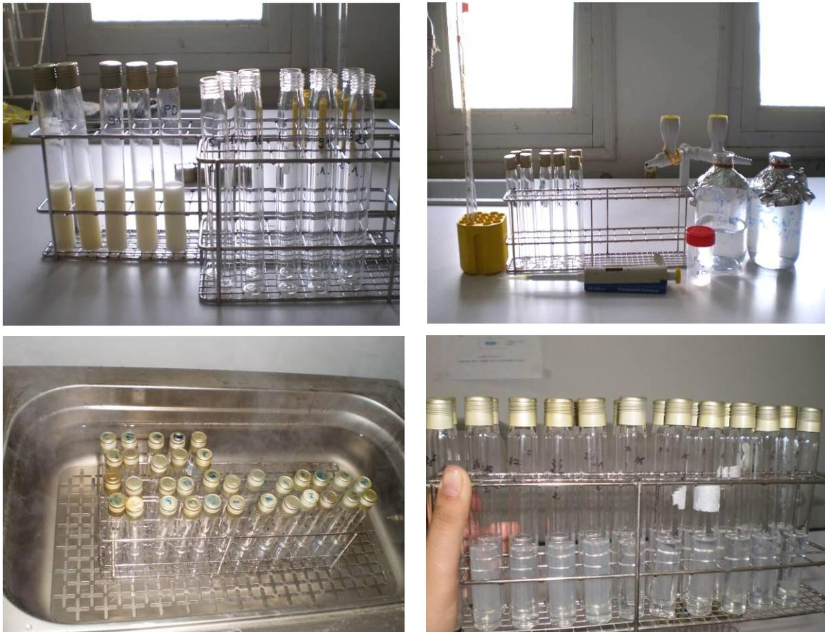
Figure 3.10 : Etapes de clarification des échantillons de lait fixé
