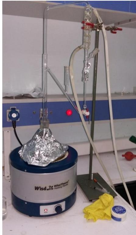
**Figure 13** : Dispositif utilisé pour l'hydro-distillation des plantes. (*Photo personnelle*)
