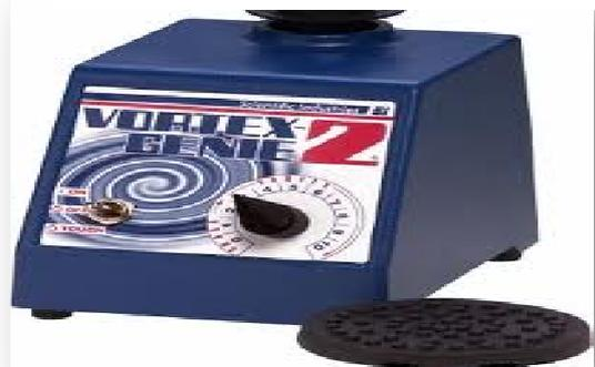
Vortex pour l'homogénéisation des prélèvements
