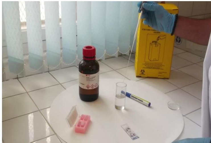
figure 35: nettoyage au xylène et montage (photo personnelle)
