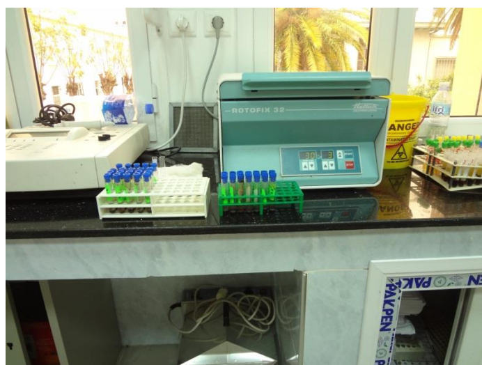
figure 26 : centrifugeuse utilisée « Hettichrotofix 32 »
