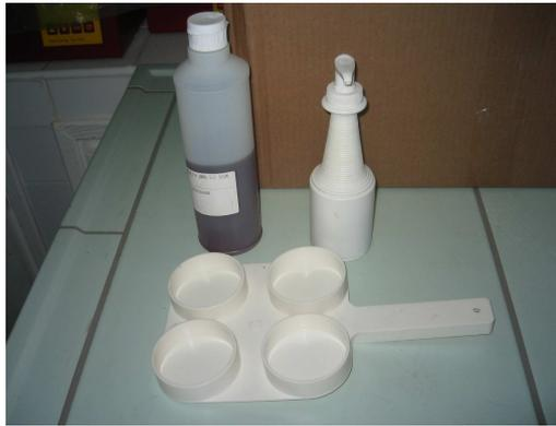
Photo 15 : Matériels utilisés pour le test du CMT
