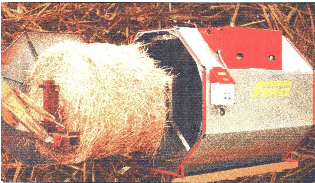
**Figure 3 : Tunnel chauffant.**
