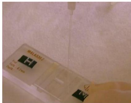
**Figure n°16:** photo réelle représentant le dépôt de l'échantillon par la pipette.
