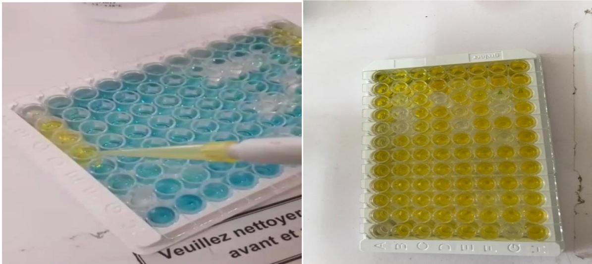
Figure 28 : Distribution de la solution d'arrêt ou de blocage. (Photo personnelle)
