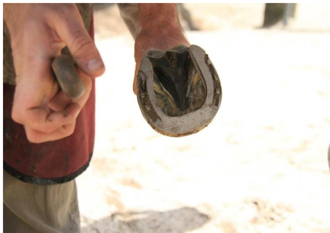
Figure 23 : Image photographique d'un fer à cheval imprimés en 3D (Liz Nickels 2018).
