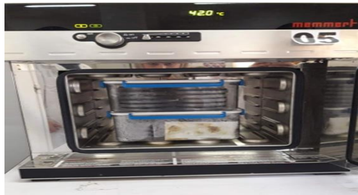
Figure 10 : Incubation des boîtes de Petri à 42°C (photo personnelle).
