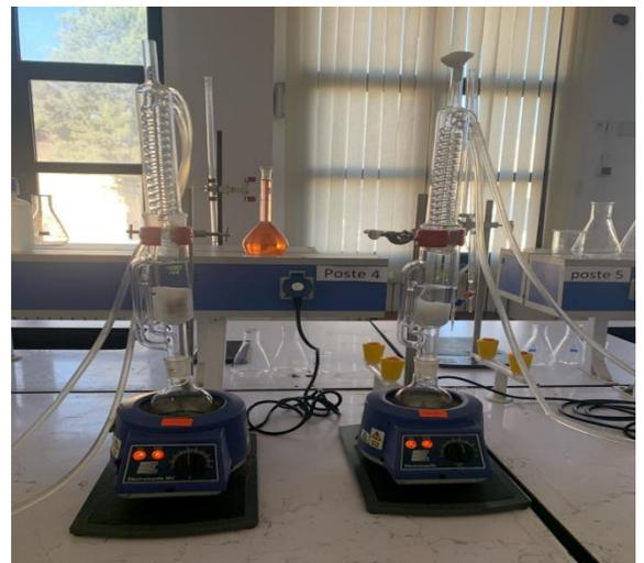
**Figure03** :appareil de soxhlet
