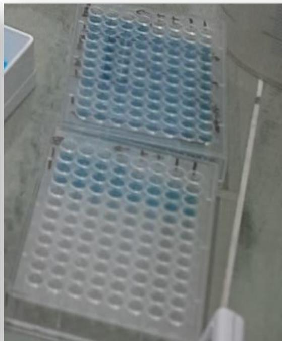
Figure 9 : Plaque de pré dilution format 96 puits(Ori-ginale, 2020).
