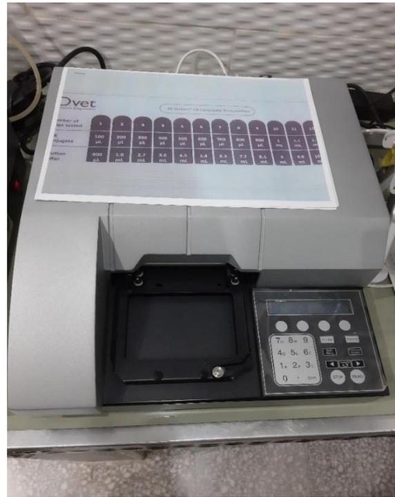
Figure 12 : Lecteur de microplaques à 96 puits (Originale,2020).
