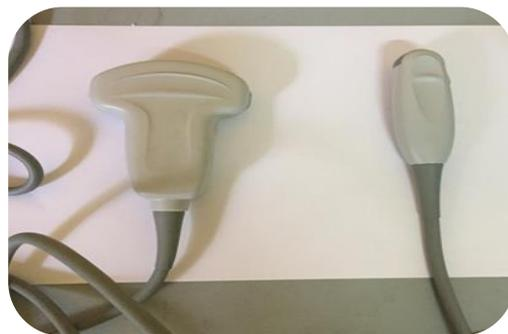
**Figure 7 : Sondes de 3.5Mhz et 7.5Mhz (personnelle).**
