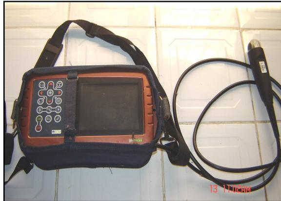
**Figure (59) :** Appareil à ultrason (échographe portable à sonde sectorielle de 3.5 et 5 MHz).
