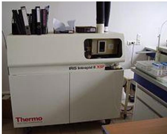
Figure 20 : spectromètre ICP-AES. (Cjp, 2009)
