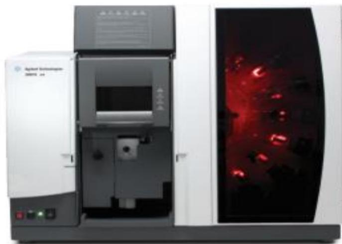
**Figure 10: spectromètre d'absorption atomique (site web 8, 2016)**
