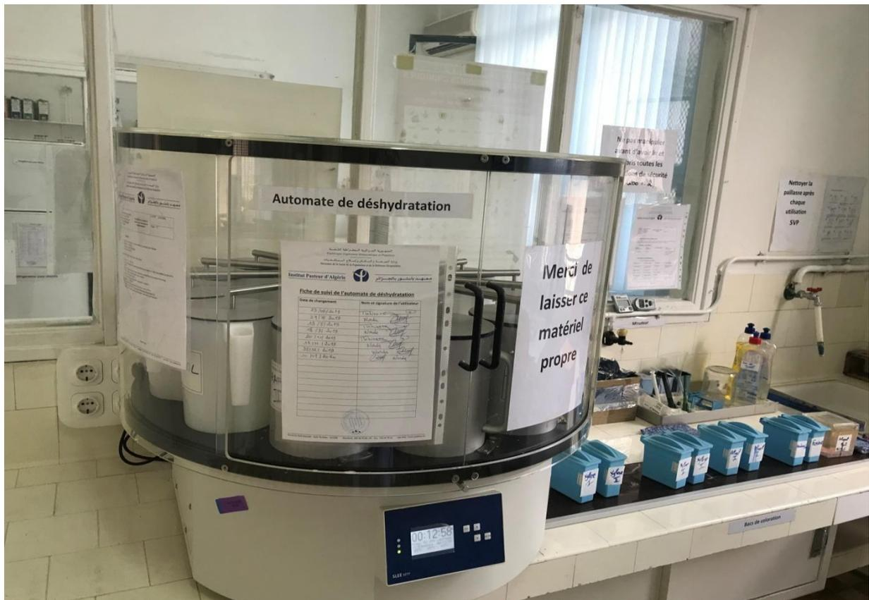
**Figure 14: automate de déshydratation (photo originale)**
