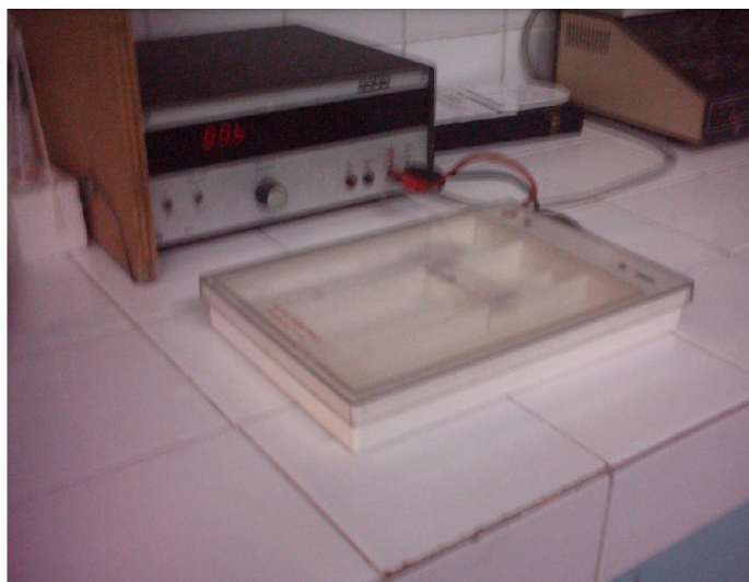
Photo 31: Générateur et cuve d'électrophorèse
