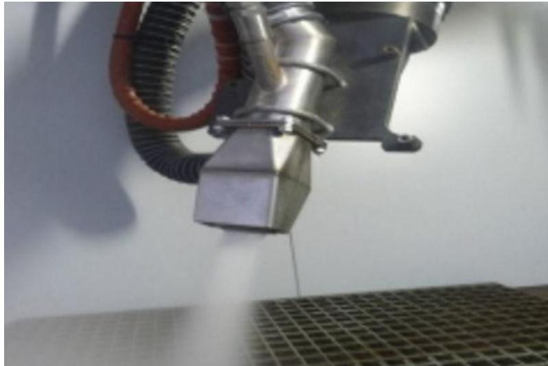
**Figure 8:** Modules de nettoyage à vapeur sèche saturée (**Hermon, 2019**).
