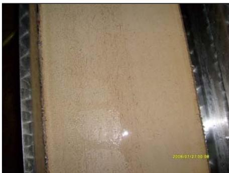
**Figure 17 :** Bande transporteuse de carcasses avec des fissures sur la totalité de la surface. (Photo personnelle)
