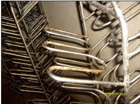
**Figure 18 :** Déposition des souillures sèches sur les surfaces des paniers.
