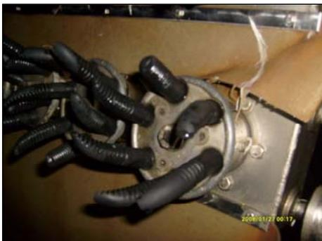
**Figure 14** : Etat des doigts plumeurs avant changement.
