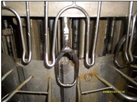
**Figure 16** : Cuillère d'éviscéreuse corrodée.
