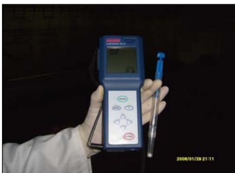
**Figure 2 :** ATPmètre « LUMITESTER PD-10 »
