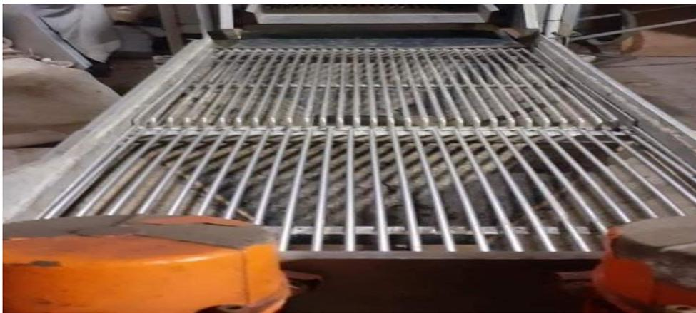
**Figure N 32 : Calibreuse**
