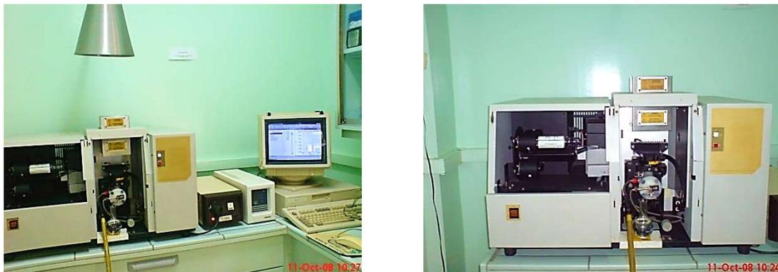
Figure 16 : Spectrophotomètre d'absorption atomique (UNICAM929).
