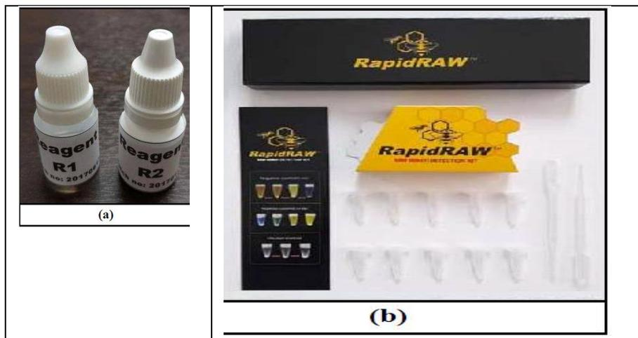
**Figure 37:** Réactif R1 solution saline physiologique et le réactif RapidRAW R2 ( a ) ; le prototype RapidRAW (b) (Nor Azfa Johari et *al.*, 2019).
